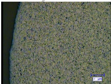
شکل ۲. تصویر OM کامپوزیت Al - 1.5 % Gr تولید شده به روش همگن شده در مایع-SPS.
