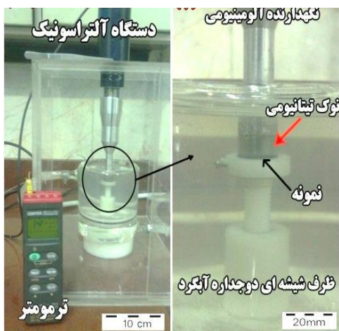
شکل ۱. شماتیکی از دستگاه آلتراسونیک مورد استفاده برای آزمون فرسایش حفره‌زایی غیر تماسی.
