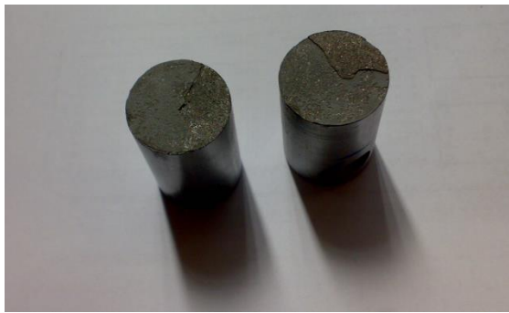
شکل ۱۰. نمونه پوشش حاوی ۲۰ درصد تقویت کننده بعد از آزمون چسبندگی.
