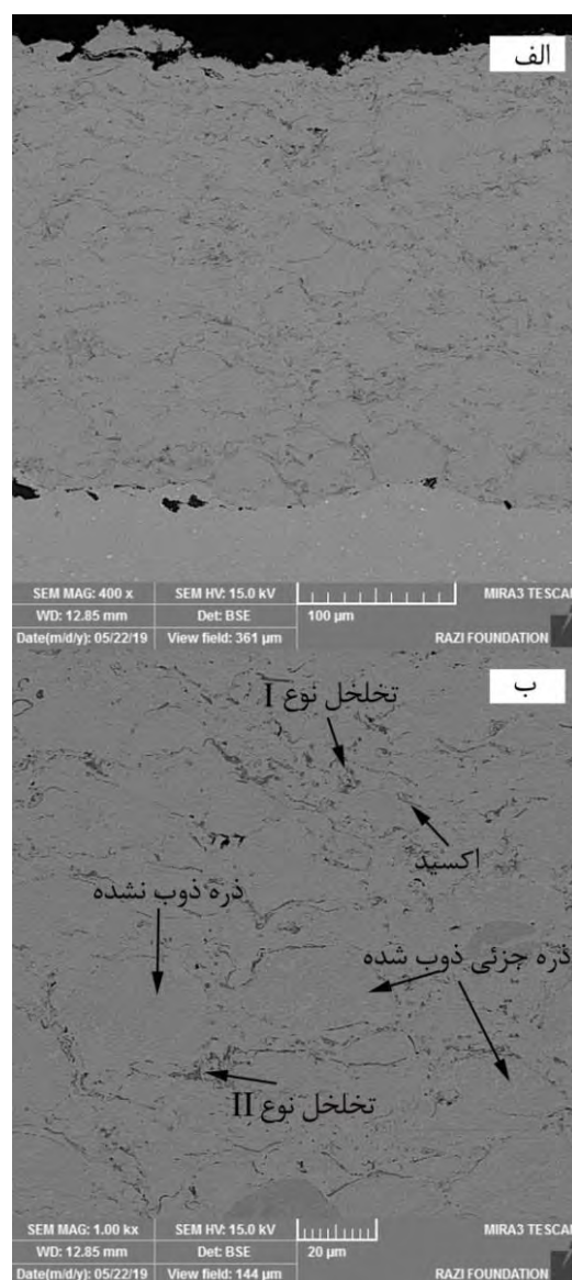
شکل ۳. تصویر میکروسکوپی الکترونی روبشی از سطح مقطع پولیش شده پوشش NiCoCrAlY ایجاد شده توسط فرایند HVOF در دو بزرگنمایی متفاوت.
