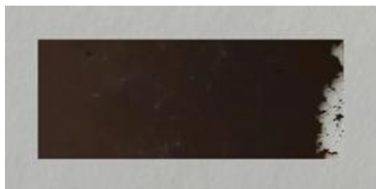
شکل ۵. تصویر ماکروسکوپی از نمونه رسوب داده شده با نرخ شارش 1:130 = \text{GeH}_4:\text{CH}_4 (S4) پس از ۹۶ ساعت قرارگیری در معرض مه نمکی.
