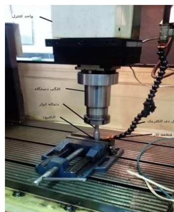
شکل ۲. نحوه بستن الکتروود و قطعه کار.
