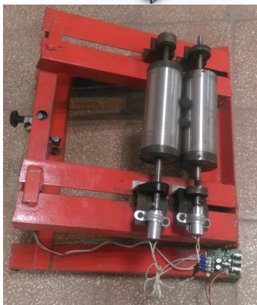
شکل ۲. تجهیز آزمایشگاهی برای مطالعه حرکت گندله بر جفت غلتک دوار.
