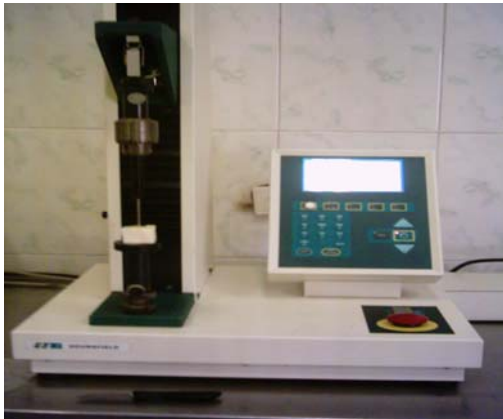
شکل ۳ - اندازه‌گیری سفتی (penetration Test)
