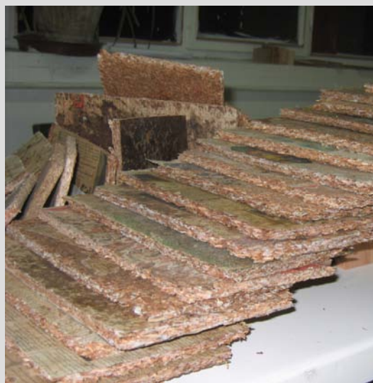
شکل ۵- نمونه‌های اولیه آزمایشی با ضخامت ۱۰ تا ۱۶ میلی متر ساخته شده از خرده چوبهای درشت
