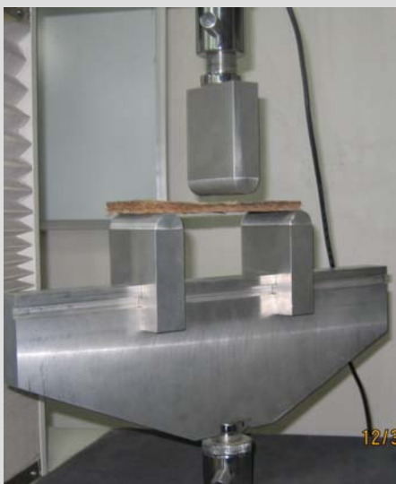
شکل ۶- نمونه قرار گرفته در دستگاه کشش و فشار برای اندازه گیری مقاومت خمشی
