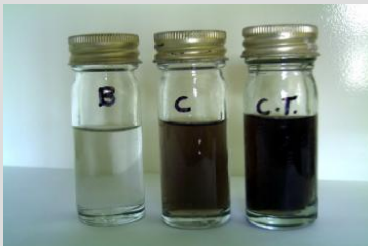
شکل ۲- محلول سانتریفوژ شده و فیلتر شده حاصل از فرایند محلول سازی ذغال سنگ بوسیله کنسرسیونم باکتریایی. B: شاهد بدون تلقیح باکتری، C: ذغال سنگ پودر شده، و C.T.: پس مانده های ذغال شویی
