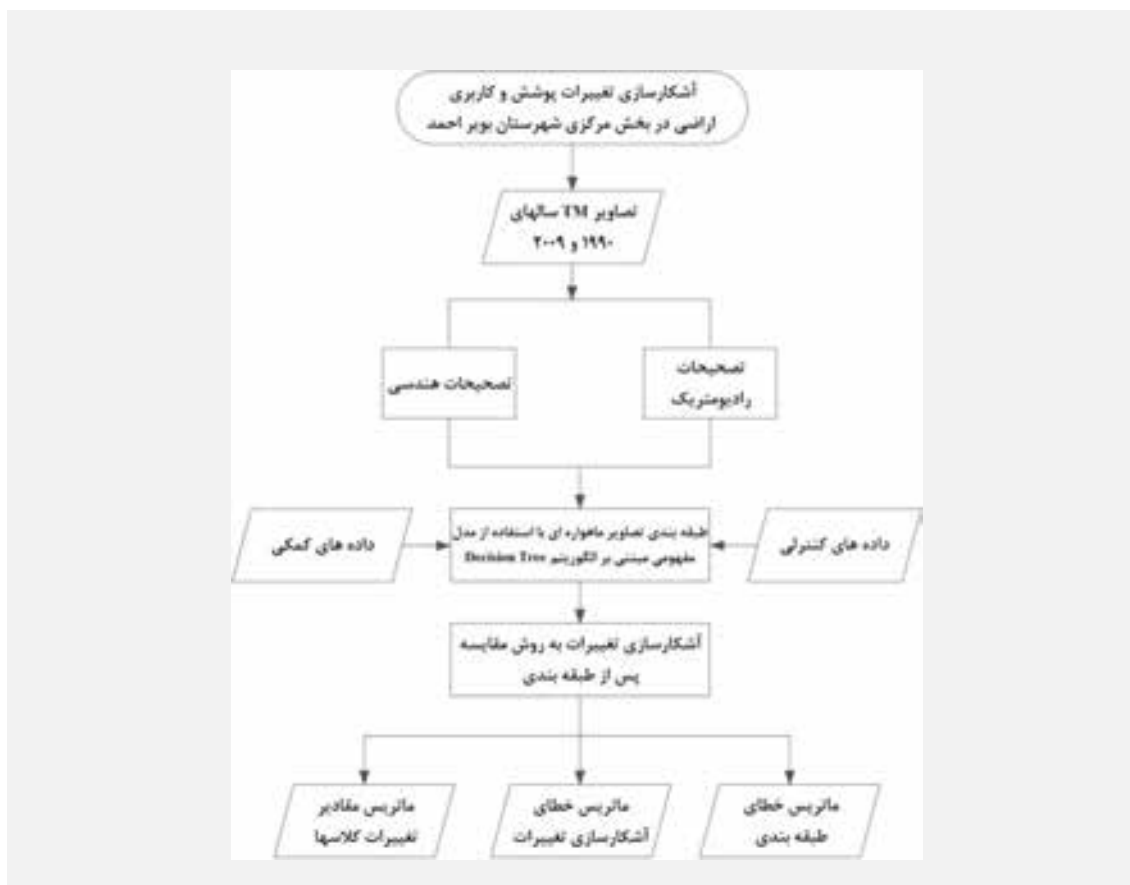
شکل ۲- فرایند آشکارسازی تغییرات پوشش و کاربری اراضی
