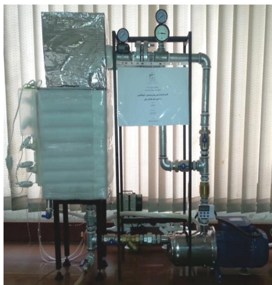
شکل ۲- تصویر پایلوت آزمایشگاهی Fig. 2- Hydrodynamic cavitation reactor
