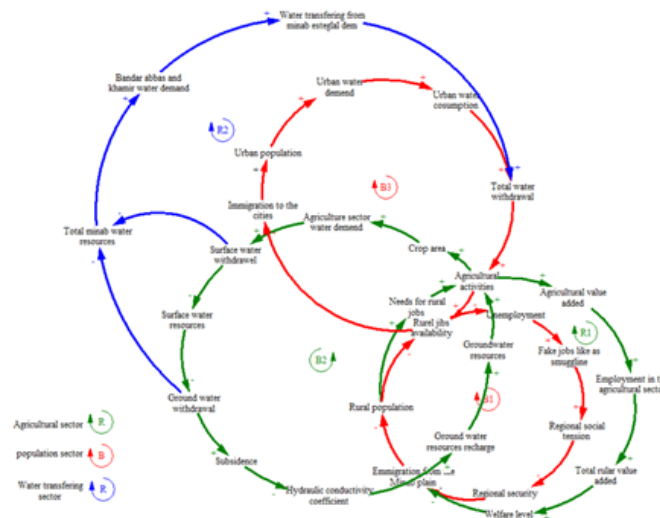
شکل ۱۵- مکانیزم سیستمی حاکم بر منابع آب دشت میناب Fig. 15- The System mechanism governing the Minab plain water resources
