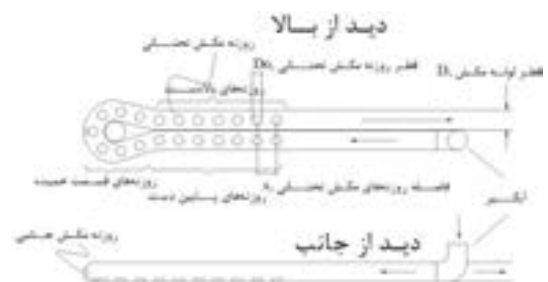
شکل ۴ نمای شماتیک سامانه لوله مکش و روزنه‌های تحتانی و جانبی بکار رفته در این تحقیق
