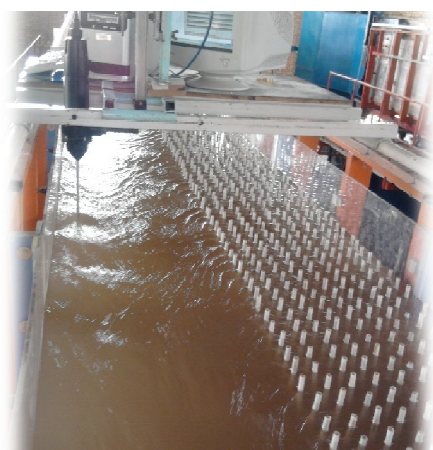
شکل 3 نمایش از المان‌های پوشش گیاهی غیرمستغرق بر روی سیلاب‌دشت و مجموعه اندازه‌گیری سرعت
