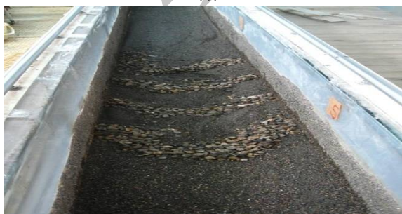
شکل 24 الف- خطوط تراز، ب- شکل سه بعدی و ج- تصویر عوارض بستر در حضور خیزآب‌های باله‌ای عرضی در آزمایش سوم ( Q_3 = 0/68 \text{ l/s} )
