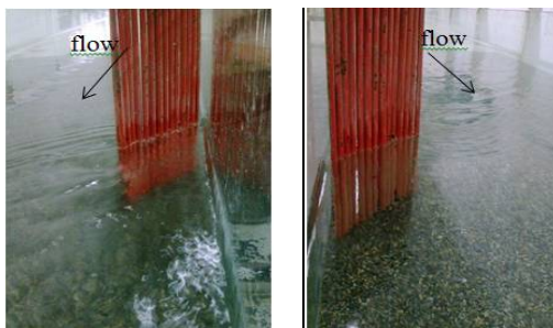
الف - مانع میله‌ای دو ردیفه زیگزگی با زاویه 45 ب - مانع میله‌ای دو ردیفه در امتداد هم با زاویه 135
