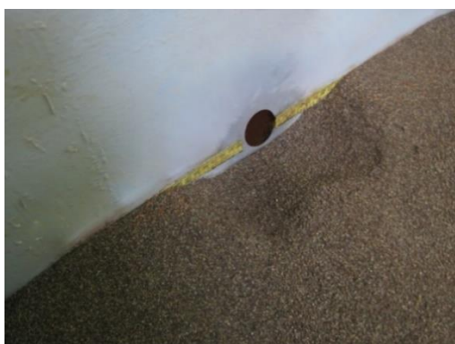
شکل ۹ مخروط رسوب‌شویی در آزمایش با سازه SFM
