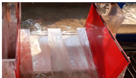
شکل ۶ نمونه سرریز با عرض ۵۰ سانتی‌متر و پایه ۱۰ سانتی‌متر
