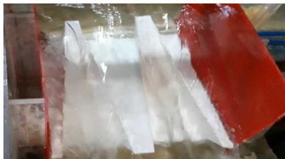
شکل ۷ نمونه سرریز با عرض ۷۰ سانتی‌متر و پایه ۱۰ سانتی‌متر
