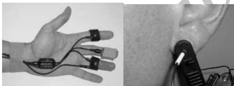
شکل ۳ - شیوه اتصال حسگرها به بدن آزمودنی ها
