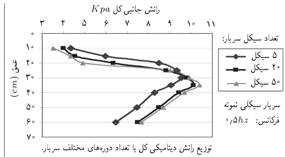
شکل ۱۲. تأثیر تعداد دوره‌های سربار بر شکل منحنی رانش خاک با عمق.
