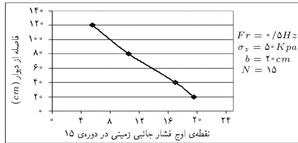
شکل ۱۱. تأثیر فاصله‌ی سربار از دیوار بر مقدار حداکثر فشار جانبی.
