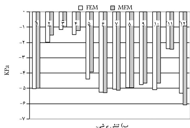
شکل ۱۵. توزیع تنش برای  $F_h = 50 \text{ kN}$
