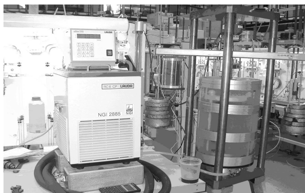
شکل ۲. نمایی از دستگاه سه محوری دوره‌ی مؤسسه‌ی NGI.
