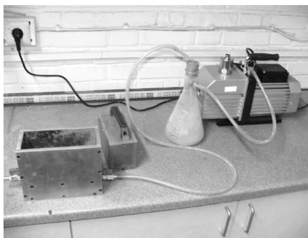
شکل ۲. قالب استفاده شده برای ساخت نمونه‌ها.
