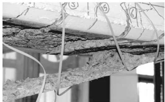
ب) نمای نزدیک از جدایشگی میانی ورق تقویتی.
