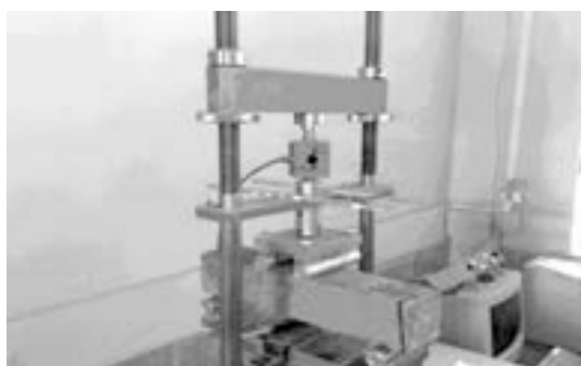
شکل ۵. شمای آزمایش خمش چهار نقطه‌یی بر روی نمونه‌ی منشوری.
