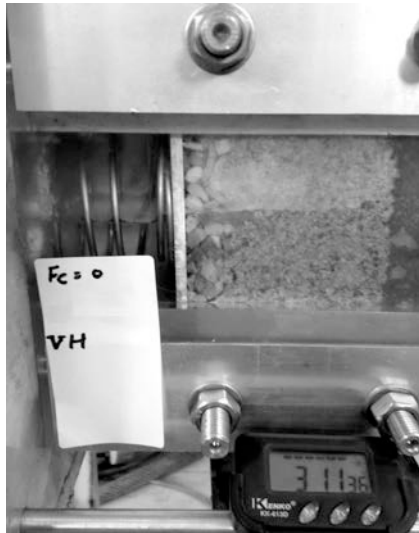
شکل ۱۱. حالت ترک خوردگی قائم و جریان افقی.
