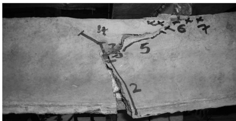
د) مد شکست در نمونه ۳. شکل ۱۰. بار نهایی و مد شکست.
