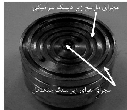
شکل ۲. بدنه‌ی پایین سلول دستگاه.
