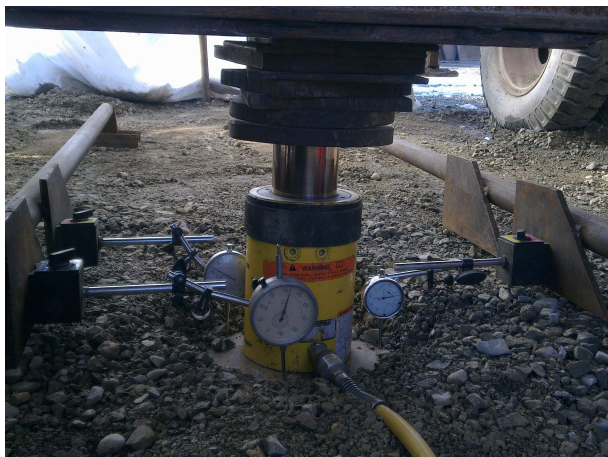
شکل ۴. تصویری از آزمایش بارگذاری صفحه. [۱۱]
