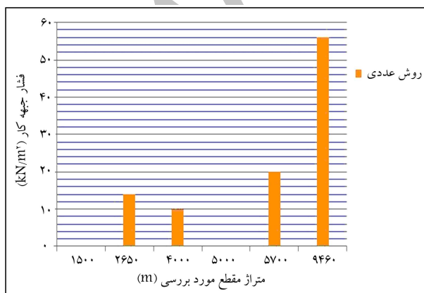
شکل ۱۲. نتایج مدل سازی عددی با استفاده از نرم افزار PLAXIS 3D برای ۶ مقطع انتخاب شده در پروژه ی خط ۷ متروی تهران.
