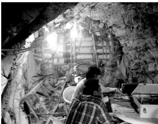
شکل ۲. آزمایش بارگذاری صفحه در گالری‌های اکتشافی به صورت قائم و افقی.
