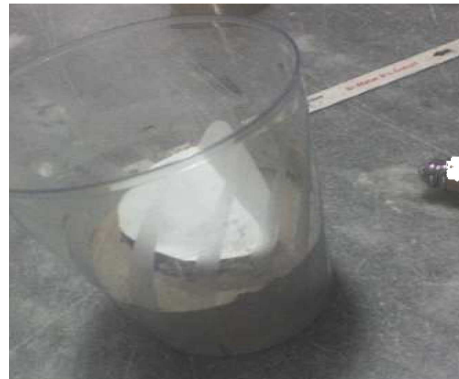
شکل ۴. نحوه‌ی قرارگیری فیلتر کاغذی در روش غیرمستقیم.
