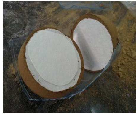
شکل ۳. نحوه‌ی قرارگیری فیلتر کاغذی در روش مستقیم.
