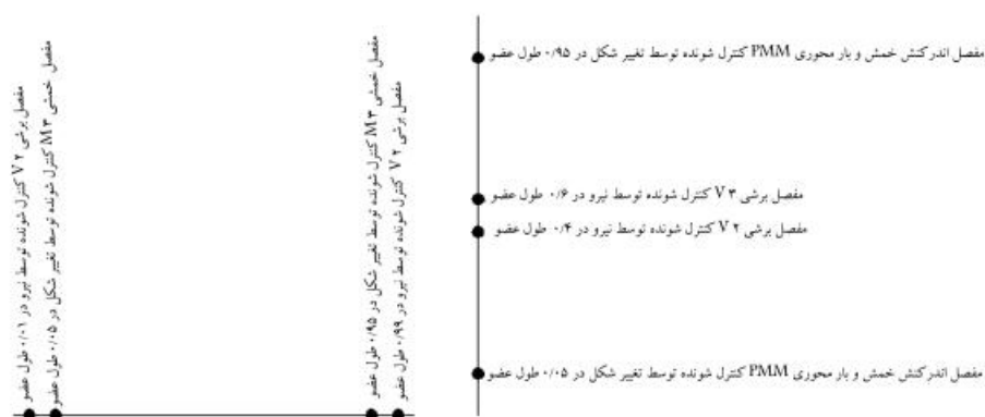
شکل ۱۹. نحوه‌ی اختصاص مفاصل در تیر و ستون قاب خمشی بتن مسلح.
