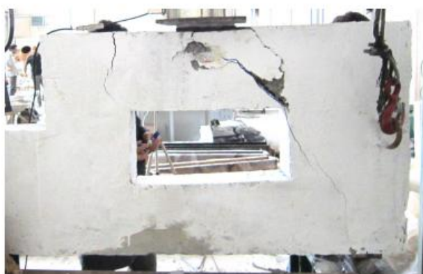
شکل ۱۷. پشت نمونه RC#۱ پس از ترک‌خوردگی.
