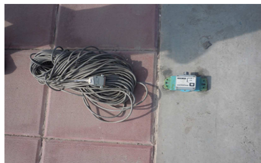
شکل ۶. حسگر شتاب‌سنج مورد استفاده در آزمایش پل بزرگمهر.
