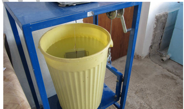
شکل ۲. دستگاه اندازه‌گیری وزن مصالح غوطه‌ور در آب.
