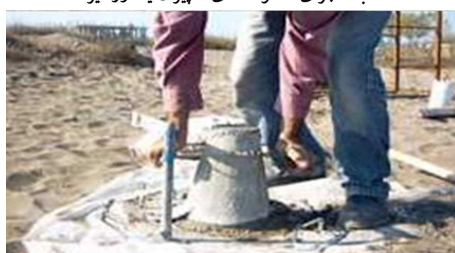
(د) آزمایش اسلامپ در حین بتن ریزی؛
