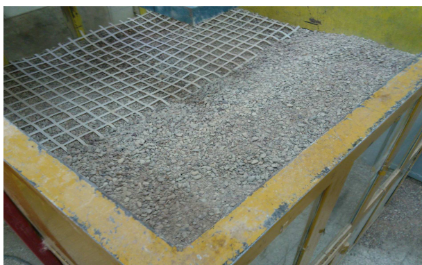
شکل ۶. نحوه قرارگیری لایه‌ی مسلح‌کننده زیر خاک.
