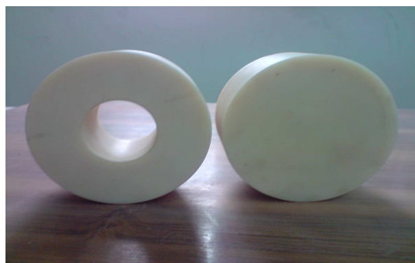
شکل ۳. پی‌های مدل حلقوی و دایره‌یی استفاده‌شده در آزمایش‌ها.
