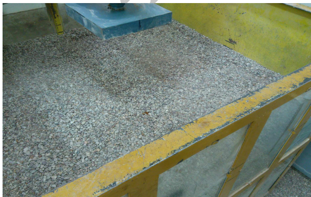
شکل ۲. محفظه‌ی خاک دستگاه آزمایش
