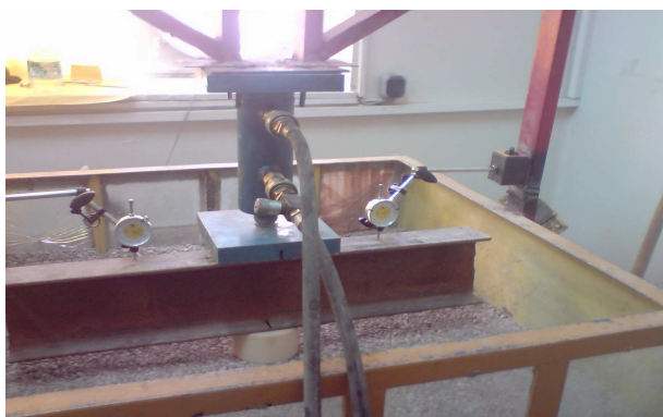
شکل ۵. نحوه قرارگیری گیج‌ها، تیرها، و پی‌ها در آزمایش‌ها.
