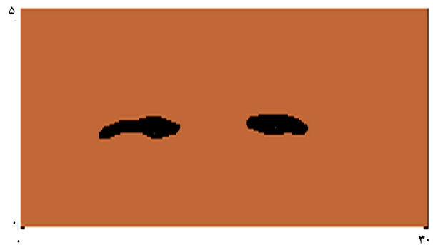
شکل ۸. توزیع لنزهای ماسه‌یی (حالت اول) در لایه‌ی رسی برای خاک نشان داده‌شده در شکل ۳.
