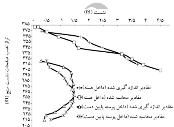
شکل ۱۲. پروفیل قائم نشست اندازه‌گیری شده و محاسبه شده در راستای محور سد و در پوسته‌ی پایین دست مقطع اصلی سد مسجد سلیمان و در انتهای ساخت.
