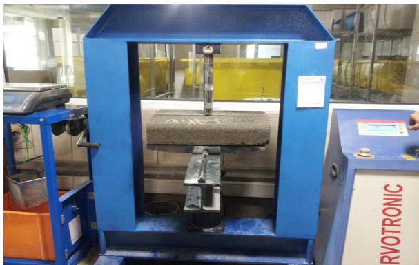
شکل ۷. نمونه‌ی جدول تحت آزمایش مقاومت خمشی.
