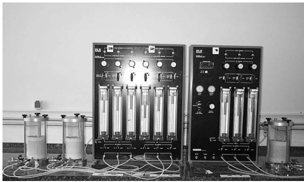
شکل ۳. تصویر آزمایش نفوذپذیری سه محوری روی رس نازلو.
