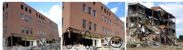
شکل ۱. آزمایش اتحادیه‌ی اوهایو: قبل از حذف ستون (سمت چپ)، بعد از حذف ستون (وسط)، در طول تخریب (سمت راست). [۲]
