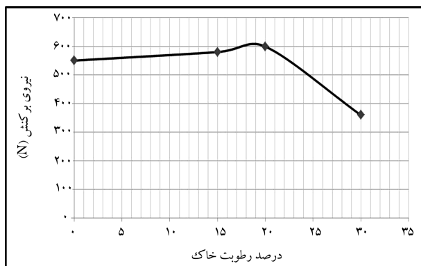
شکل ۱۱. نحوه تغییر بیشینه‌ی مقاومت برکنش لوله با تغییر درصد رطوبت خاک.
