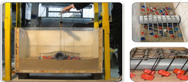
شکل ۲. استفاده از سیستم مهار - شبکه در آزمایشگاه.
