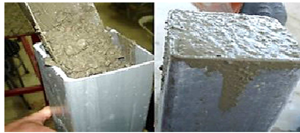
شکل ۱. ریختن بتن در داخل پروفیل GFRP. [۵]
