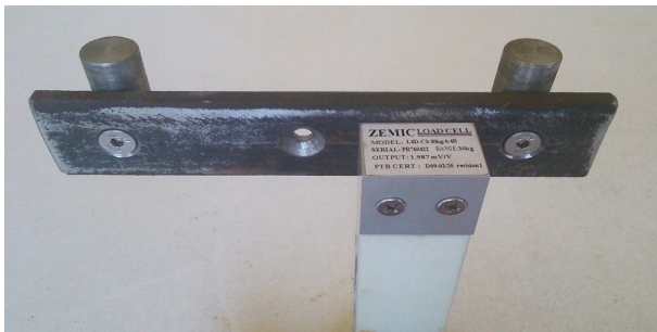
شکل ۹. نحوه ی اتصال قسمت متحرک لودسل.
