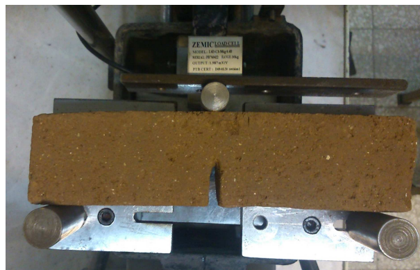
شکل ۱۴. نحوه‌ی قرارگیری نمونه داخل دستگاه برای تعیین طاق‌ت شکست مد ۱.
