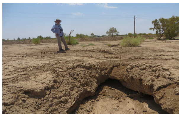
شکل ۱۲. وجود یک لایه با تراوی و پتانسیل فرسایش بالا در زیر لایه‌ی رسی سطحی.
