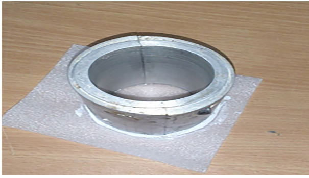
شکل ۴. تصویر قالب عمل آوری نمونه‌های آزمایش قبل از انتقال به دستگاه انجاماد.
