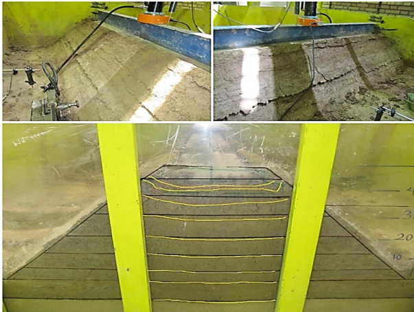
شکل ۲۲. نشست‌ها و سطوح گسیختگی در خاکریز ELM3.
