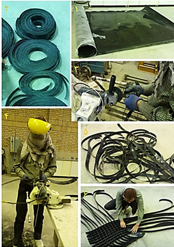
شکل ۸. مراحل ساخت ژئوسل: (۱) ورق ژئوممبرین، (۲) برش ورق ژئوممبرین به صورت تسمه‌های ۵ سانتی‌متری، (۳) و (۴) شیارزنی ورق با فرز استیل بر، (۵) تسمه‌های شیارزنی شده، (۶) فرو بردن تسمه‌ها در یکدیگر و ساخت خانه‌های ژئوسل.
