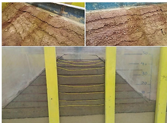
شکل ۱۵. نشست‌ها و سطوح گسیختگی در خاکریز ELM o .
