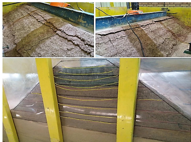
شکل ۲۴. نشست‌ها و سطوح گسیختگی در خاکریز ELM4.
