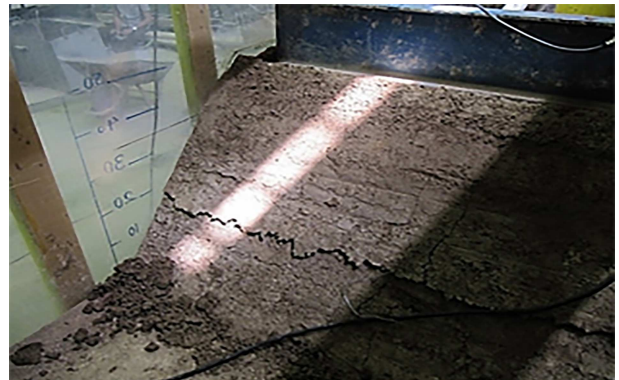
شکل ۱۹. گسیختگی خاکریز ELM2 در ارتفاع ۲۰ سانتی متری از بستر اصلاح شده.
